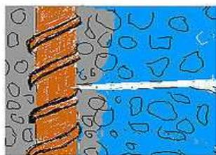
EL FRENTE DE CARBONATACIÓN SIGUE AVANZANDO Y CON MÁS INTENSIDAD A TRAVÉS DE LAS FISURAS O CAPILARES QUE LLEGAN A LA ARMADURA. EN ESE PUNTO EL PH ES INFERIOR A 9 Y EL HIERRO ESTÁ DESPASIVADO
