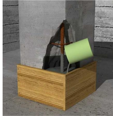
Reparación Mediante Morteros Fluidos
