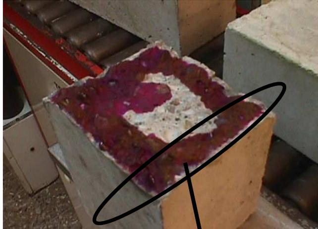
Test de Fenofaleína; probeta laboratorio expuesta ambiente carbonatación.
