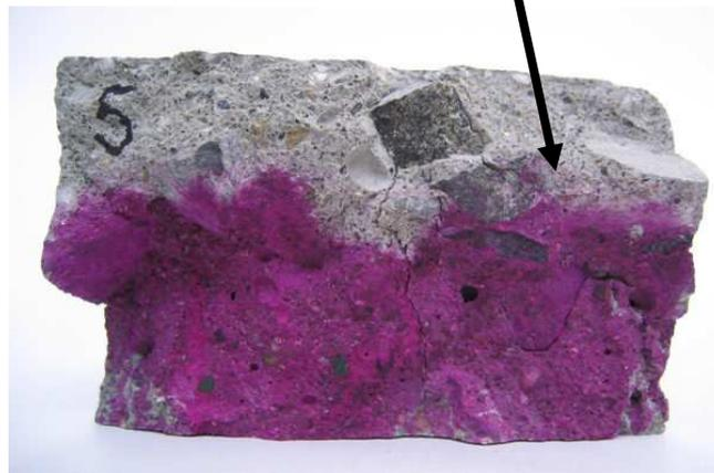
Hormigón Carbonatado (zona coloreada - hormigón sano)
