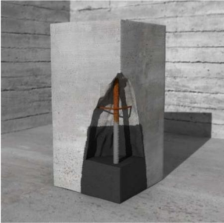
Reparación Mediante Mortero Tixotrópico
