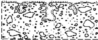
Representación esquemática de una Impregnación Hidrófoba
