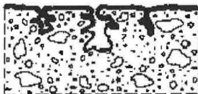
Representación esquemática de una Impregnación
